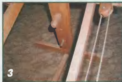
Регулировочное устройство. Здесь хорошо видна дубовая «гайка» фиксирующего болта.
