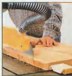
Первая рабочая операция — обрезка досок.
